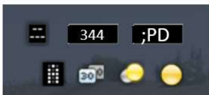
Ejemplo para una señal intermedia en BAD y que es Permisiva
