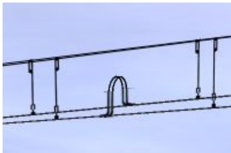
Figura 3.5. Cable RA (contiene los conductores de conexión) y Cable R
