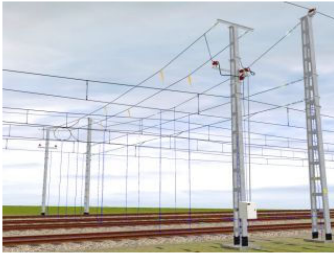
Figura 5.1.5a. Seccionador Z4 para alimentación de vías secundarias.
