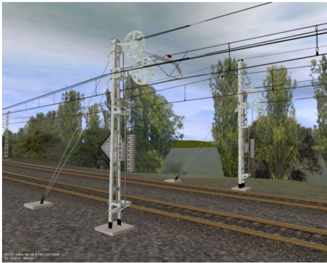
Figura 1.b. Equipo de regulación independiente para sustentador e hilos de contacto.
