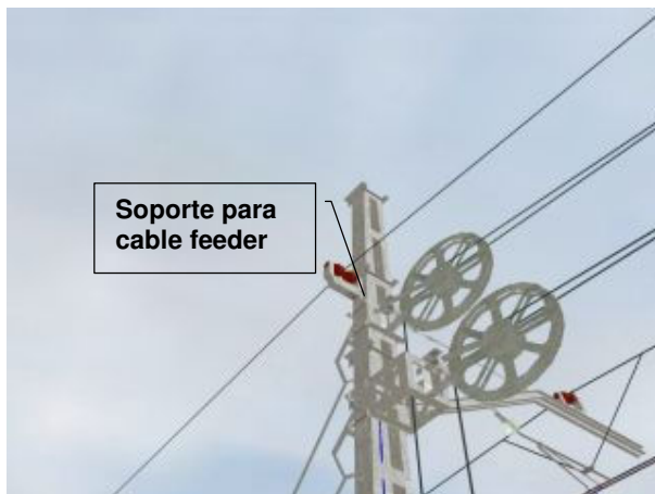
Figura 5.1.9 Soporte para cable feeder.
