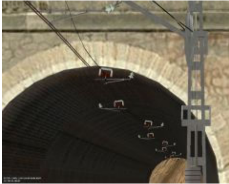
Figura 3.9. Cables de embocadura a túnel y de interior
