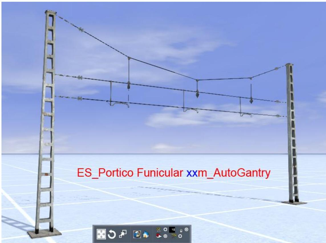
Estos pórticos se colocan de forma automática, pero sus atirantados se colocan por separado. Tendréis disponibles 4 tipos de pórticos: de 17m, 21,5m, 26m y 30,5m.
