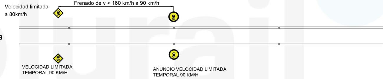
Instalación de señales de velocidad para una limitación a 90 km/h en una línea con v < 160 km/h y posterior limitación a 140 km/h
