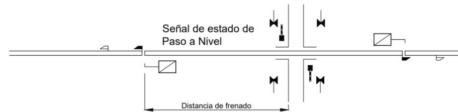
Instalación de señales en caso de visibilidad < 300 m. de la señal indicadora
