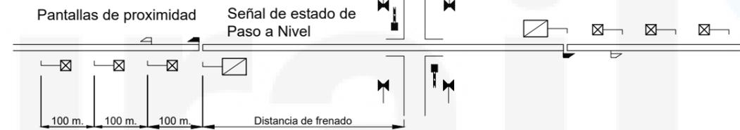
Instalación de señales en caso de visibilidad > 300 m. de la señal indicadora, tres pasos a nivel
